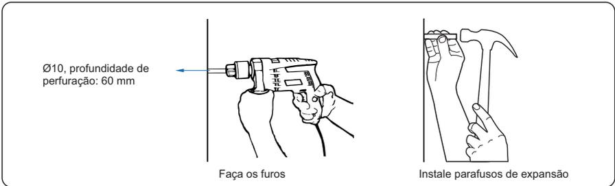
Figure 4.12 Faça furos e instale a expansão (uint: mm)
